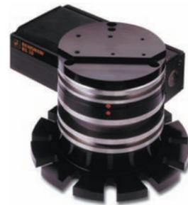
로터리 축 측정에는 RX10 로터리 축 키트를 사용할 수 있습니다. XL-80 시스템 및 앵글러 옵틱과 사용할 때 이 고정밀도 인덱싱 테이블은 1 arc second의 정확도로 완벽한 자동축 캘리브레이션 을 제공합니다.
