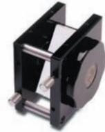
고정형 회전 미러 이 미러는 레이저 빔을 90° 각도로 반사합니다. 스위블 미러와 마찬가지로 측정 옵틱에 부착하여 광학적 셋업에 활용할 수 있으며, 측정이 필요한 축에 접근이 제한될 때 주로 사용됩니다.
