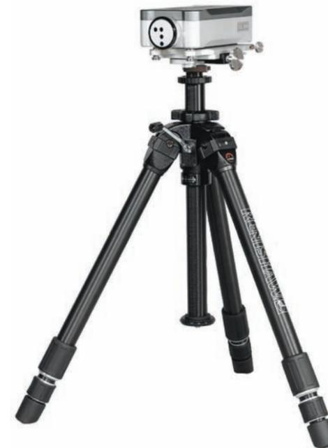
"신속한 장착/탈착" 메커니즘을 통해 빠르고 안전하게 삼각대에 고정시킬 수 있습니다. 공작 기계 테이블 직접 탑재형과 같이 삼각대 장착 방식이 편리하지 않은 경우 M8 나사와 옵션 사양인 어댑터를 사용하여 대부분의 표준 자기 베이스에 받침대와 레이저를 장착할 수 있습니다.
