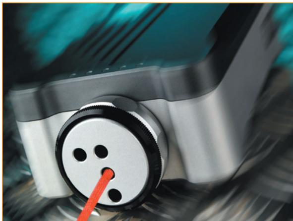
En la mayoría de las mediciones láser, la máxima imprecisión se produce por las variaciones en las condiciones ambientales (temperatura del aire, presión atmosférica, humedad) comparado con valores nominales. Incluso pequeños cambios en las condiciones pueden alterar la longitud de onda del láser y, por consiguiente, el resultado de las lecturas de medición. Por ejemplo, los cambios siguientes aumentan la longitud de onda del láser en 0,25 ppm (partes por millón):
