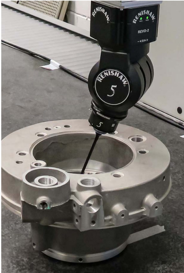
REVO 5 軸測頭座提供無段定位能力
